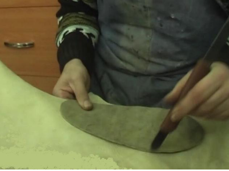
Şekil 2. Ayakkabı kalıbının deri üzerine yerleştirilip bıçak ile kesilmesi
